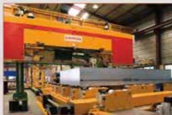
Пила продольной резки для производства плит и блоков (допуск по толщине +/- 0,2mm и коэффициент шероховатости поверхности Ra < 20 µm)
