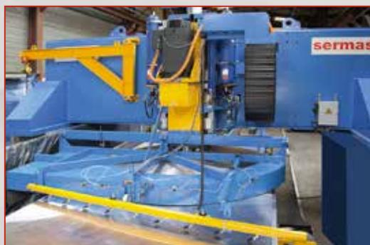
Фрезерная машина для обработки поверхности плит
