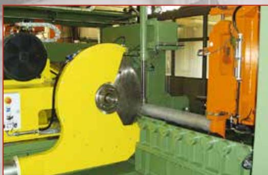
Тяжёлая мощная дисковая пила для круглых слитков небольшого размера
