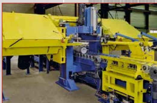
Тяжёлая мощная дисковая пила для круглых слитков большого размера
