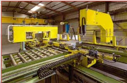
Парная дисковая ленточная пила для обрезки кромок и порезки литых плоских слитков
