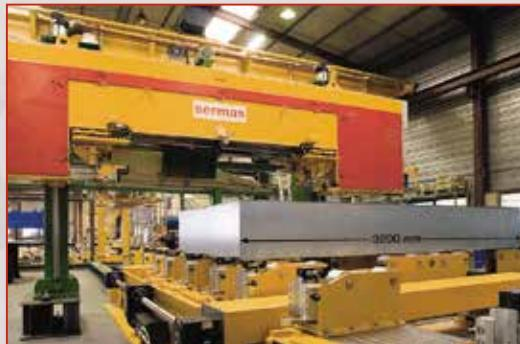
Пила продольной резки для производства плит и блоков (допуск по толщине +/- 0,2 mm и коэффициент шероховатости поверхности Ra < 20  $\mu\text{m}$ )
